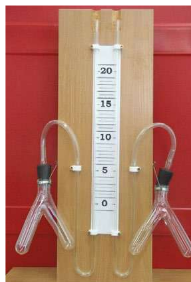
Рис. 19. Прибор для определения скорости химических реакций
